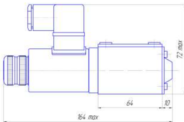
а) узел управления со стороны канала "А" для схем 573, 574, 574А, 14-А...154-А
